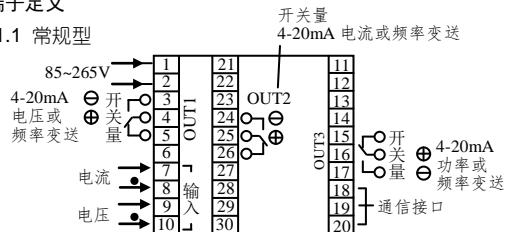
注：功率变送 4~20mA 对应 0~电压量程 × 电流量程，单位是 kW；
