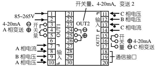
RS232 通信: 18-TXD; 19-RXD; 20-GND; RS485 通信: 19-A; 20-B
