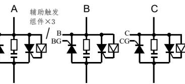
图12: C7型应用。单硅反并联, Y/ $\Delta$ 形接法。自动适应相序。如果采用单硅和二二极管反并联, 则不接图中三个辅助组件
