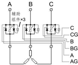
图5: C7应用。三相三线制移相触发, Y或 $\Delta$ 。如果采用单硅和二极管反并联, 则不接图中三个辅助组
